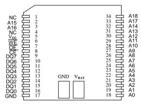
34-Pin POWERCAP MODULE (PCM) (USES DS9034PC POWERCAP)
