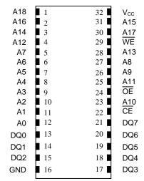
32-Pin ENCAPSULATED PACKAGE 740-mil EXTENDED
