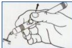
Установив микросхему на плату, легко нажмите на рычаг для сброса вакуума
