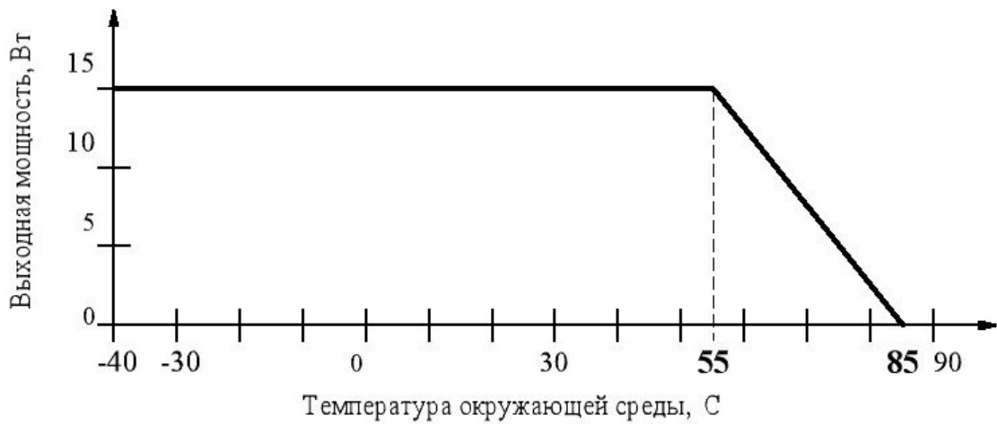
Рисунок Е.2 – Зависимость выходной мощности от температуры окружающей среды в условиях естественной конвекции (для К.П.Д. = 80 %)
