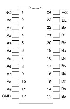
SOIC/ QSOP/ TSSOP TOP VIEW
