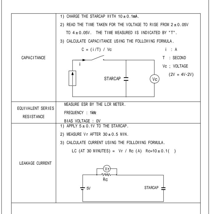
THE STARCAP SHOULD BE SHORTED BEFORE EACH MEASUREMENT AS FOLLOWS;
