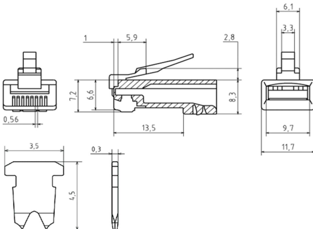
**TPR-8P8C-S2 Вилка RJ-45 для плоского и круглого одножильного кабеля**
