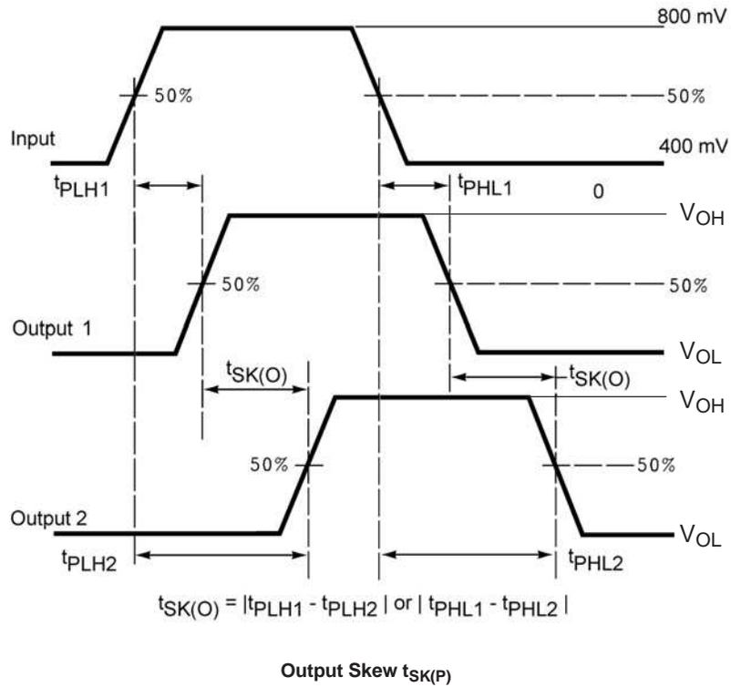
**Figure 13. Skew Test**
