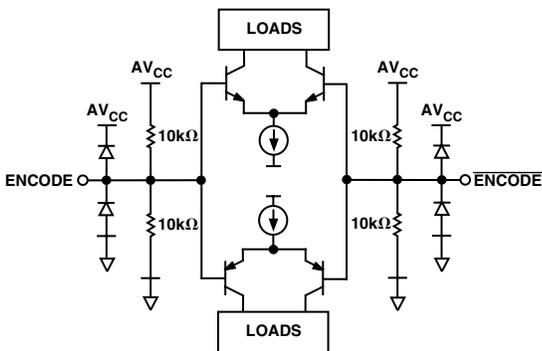
Figure 3. ENCODE Inputs
