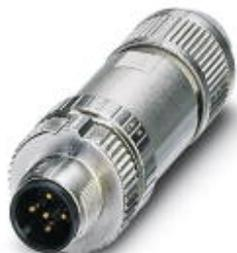
Шинный системный соединитель, CANopen®, DeviceNet™, 5-полюсн., экранирован., Штекеры прямое M12, A-кодирование, Зажимы Push-in, материал накатанной гайки: Цинк. литья под давлением, с никелевым покрытием, наружный диаметр кабеля 4 мм ... 8 мм
