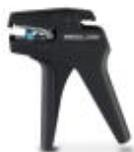
Инструмент для снятия изоляции, для проводов и кабелей сечением от 0,08 до 2,5 мм, саморегулирующийся, длина зачищаемой части провода до 15 мм, режущая способность: жесткие провода до 1,5 мм<sup>2</sup>, гибкие провода до 6 мм<sup>2</sup>
