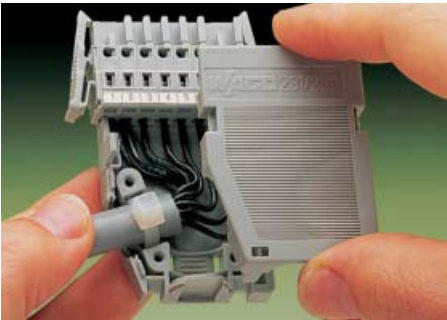
Установка корпуса на розетку с фиксаторами, вывод кабеля вбок, крепление кабельной стяжкой. (шириной до 4 мм).
