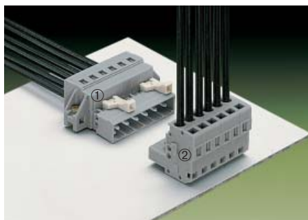
① Вилка с крепежными фланцами, с зажимом CAGE CLAMP® ② Угловая розетка, выход проводников со стороны защелок
