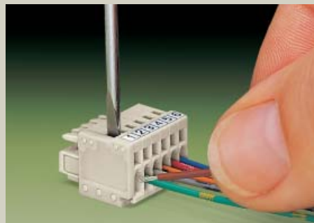
Подсоединение проводников – боковое подключение при помощи отвертки с лезвием (2.5 x 0.4) мм
