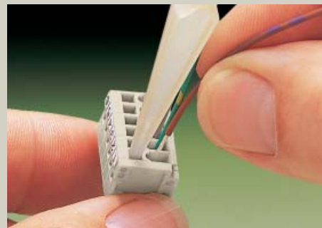
Подсоединение проводников – фронтальное подключение Серия 733 – при помощи инструмента 233-332 Серия 734 – при помощи отвертки с лезвием (2.5 x 0.4) мм
