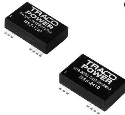
Die DC/DC-Konverter der Serie TES 5 bieten sehr leistungsfähige 5 W Module mit geringer Bauhöhe in einem kompakten SMD-Gehäuse 33.4 x 20.6 x 10.2 mm. Die 21 Modelle haben einen weiten 2:1 Eingangsbereich und genau regulierte Ausgangsspannungen. Der hohe Wirkungsgrad erlaubt einen Arbeitstempurbereich bis +71 °C bei Vollast.
