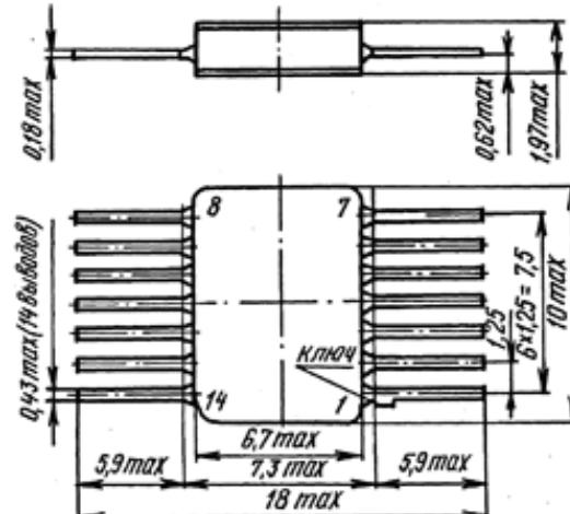
Рисунок 1. Габаритные чертежи корпусов 401.14-4 и 401.14-5М
