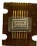
Оптопары транзисторные, состоящие из кремниевого планарного составного транзисторного приёмника и меза-эпитаксиального инфракрасного диодного излучателя, в металлическом корпусе, предназначены для коммутации цепей постоянного тока с гальванической развязкой между входом и выходом.
