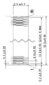
Adaptable connecter:HIROSE FH23-45S-0, 3SHW (05)
