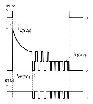
**Figure 4a:** Overtemperature: Reset if  $T_i < T_{it}$
